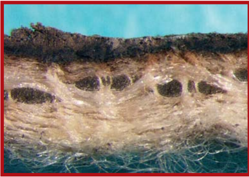
Fig 1. Tvärsnitt av filterslang från ett gjuteri efter två års användning.
